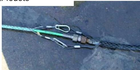
Installation correcte en THP et UHP anti-fouet sur raccord flexible-flexible.
