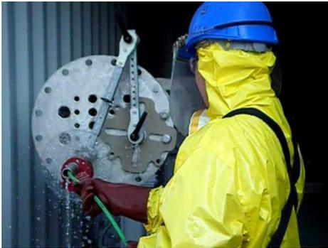
Echangeurs à faisceaux tubulaires équipés d'un pantographe.
