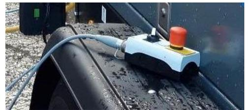
Exemple d'arrêt d'urgence déporté avec bouton de mise hors pression instantanée
